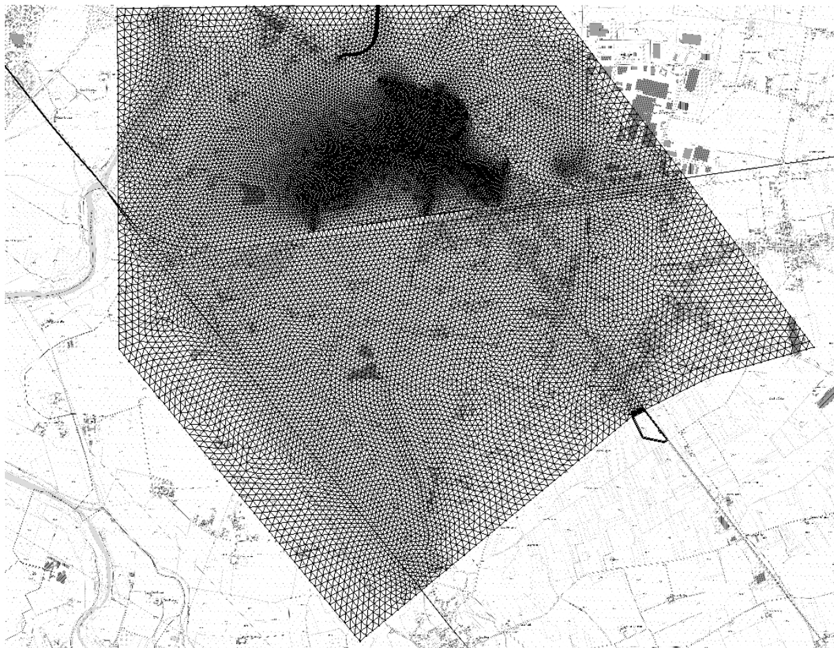
Figura 8.5: Mesh di calcolo adottata per la simulazione bidimensionale su BDTRE Regione Piemonte
